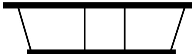
Pont caisson multicellulaire
