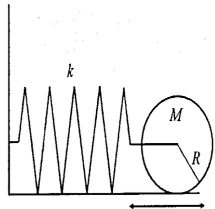
Figure 2 – Cylindre attaché à un ressort
