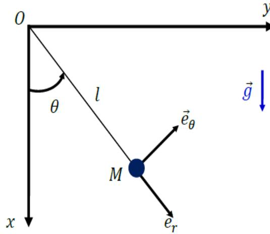
On écarte le pendule d'un angle  $\theta$  de sa position d'équilibre ( $\theta=0$ ) et on le lâche sans vitesse initiale. Les forces de frottement sont supposées inexistantes.
