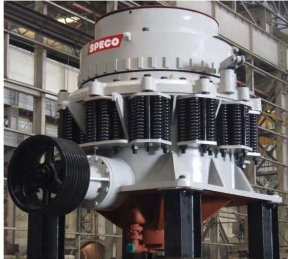
La rotation du manchon excentrique communique à l'arbre pendulaire, et par conséquent au cône d'usure qui est fixé dessus, un mouvement qui rapproche celui-ci successivement de chacun des points de l'anneau concave. Au cours de ce mouvement, les blocs à concasser se trouvent fragmentés par la pression développée, et les morceaux réduits sont évacués sur le côté de la machine par un couloir logé à l'intérieur du bâti.
