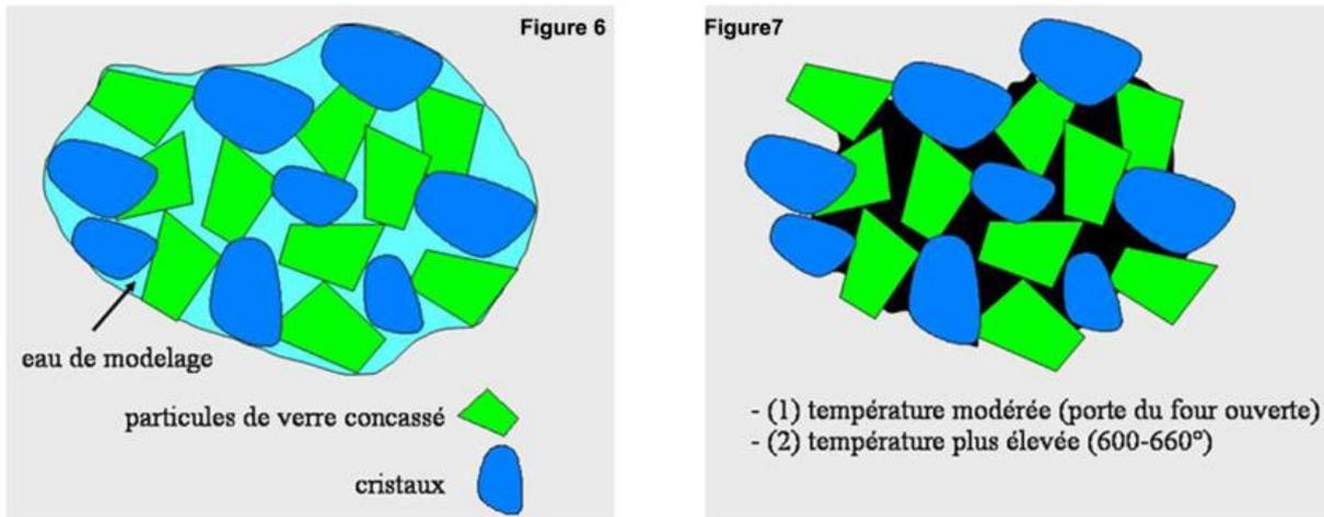
**b) Condensation :** Une granulométrie distribuée (gros grains et petits grains de taille 10 fois plus petite) et l'élimination de l'eau utilisée pour le modelage par vibration, pompage, permettent un rapprochement des particules une diminution de la porosité (qui reste de 30 à 40%) et une rétraction limitée. La condensation influence aussi la résistance de la céramique.
