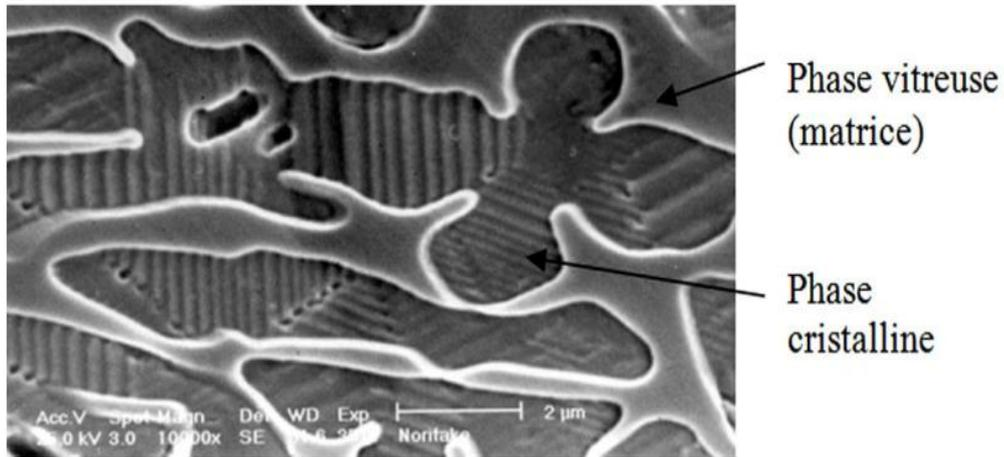
L'incorporation de cette phase cristalline dans la matrice vitreuse a permis une amélioration significative de la dureté et de la résistance des céramiques par rapport à celles des verres.
