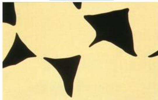
**Figure 18 : Croissance des « cous » - Formation d'un réseau de pores interconnectés -Rapprochement du centre des particules (rétraction = 0,3%)**
