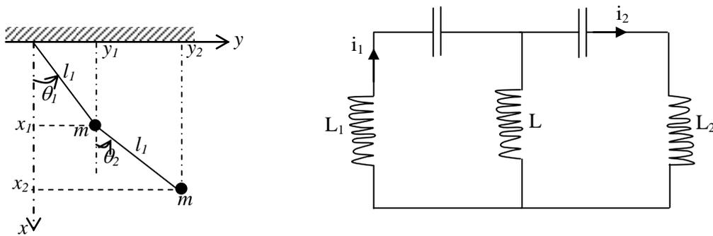
Fig. IV-2. Systèmes mécanique et électrique couplés par inertie
