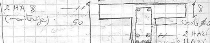
E : section en T avec armature
