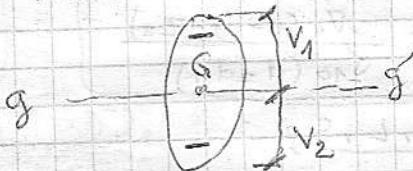
$G$ , Centre de gravité de la section homogène.
