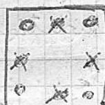
o section rectangulaire : on ne prend en compte que les armatures situées au niveau des angles.
