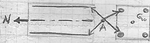
béton tendu négligé et le centre de gravité de béton est confondu avec le C. d. g. ( $s = \frac{f_e}{2}$ ) des armatures
