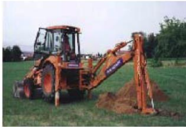
Figure 7. Sondage pédologique à l'aide d'un tracto-pelle
