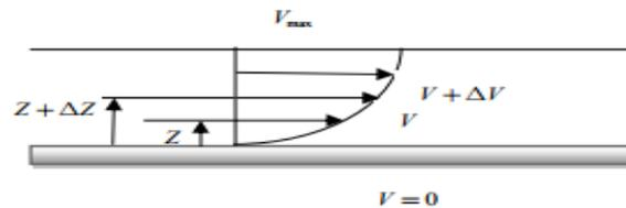
Figure II.4 : Profil de vitesse d'une particule.
