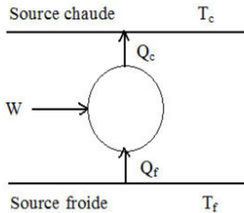
**Figure 13:** Machine frigorifique et pompe à chaleur
