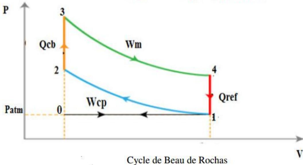
Le rendement d'un moteur à essence ne dépend que du taux de compression  $\alpha = \frac{V_A}{V_2}$
