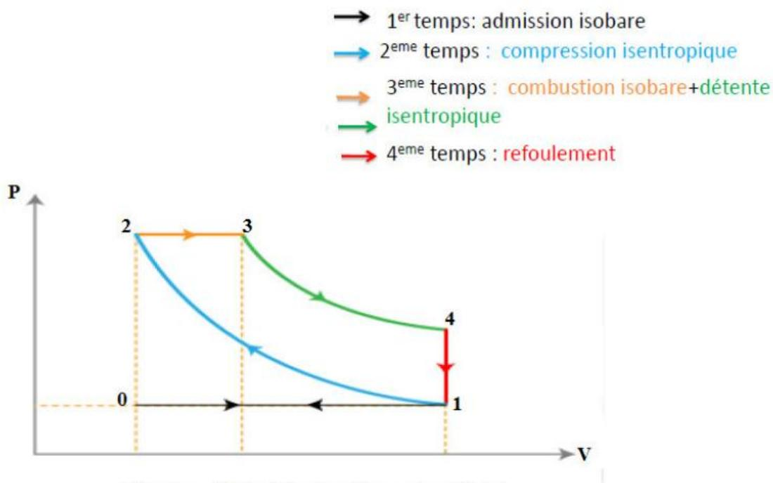
**Figure** :Cycle théorique d'un moteur Diesel
