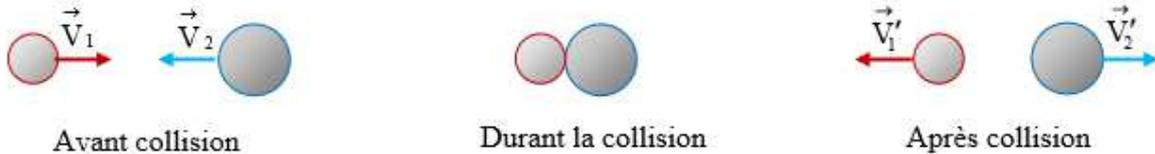
Ici, le principe de conservation de la quantité de mouvement du système formé par les particules est donc vérifié avant et après la collision.
