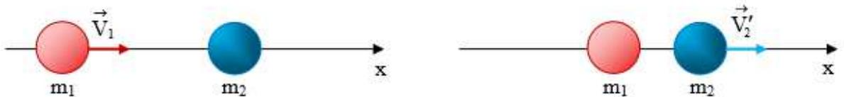
Ainsi la particule qui était en mouvement s'arrête et celle qui était initialement au repos se met en mouvement avec la vitesse d'incidence de la première.
