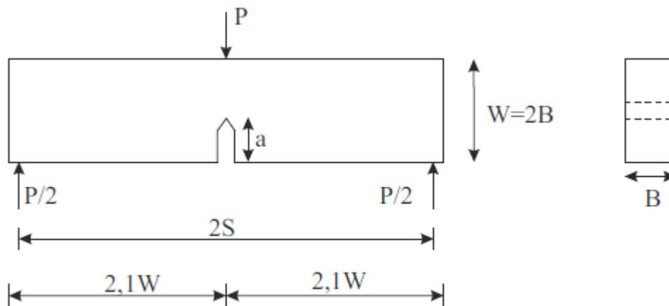
Figure 1.14 – Éprouvette de flexion en trois points.
