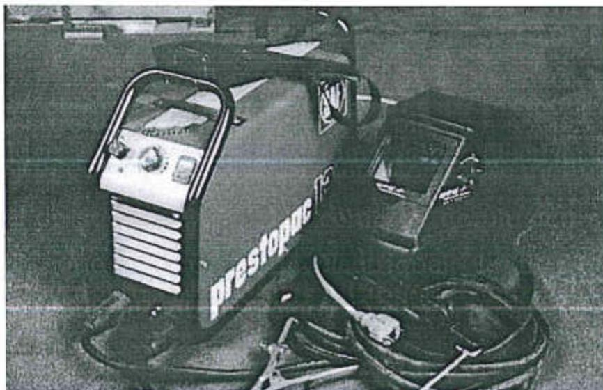
Figure 2: Matériel de soudure à l'arc électrique
