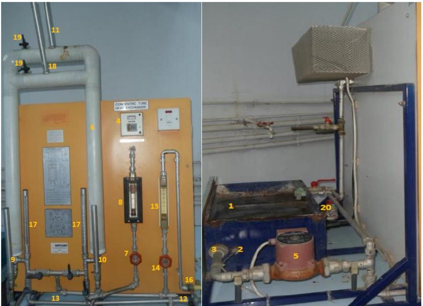
*Fig : échangeur de chaleur à tubes concentriques*
