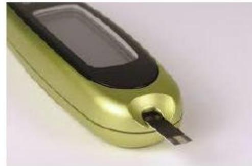
➤ **Biocapteur à glucose (glucomètre):** Utilise la glucose oxydase (GOD ou GOx) immobilisée
