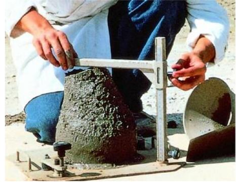
**Figure1** : Essai d'affaissement
