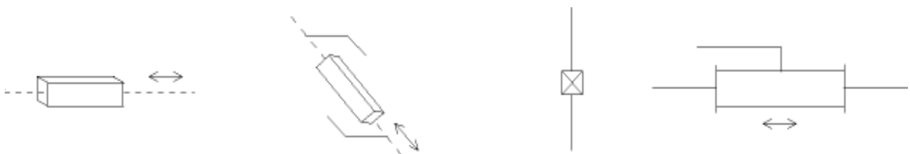
Figure : Symbole de l'articulation prismatique .
