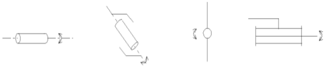
Figure : Symbole de l'articulation rotoïde .
