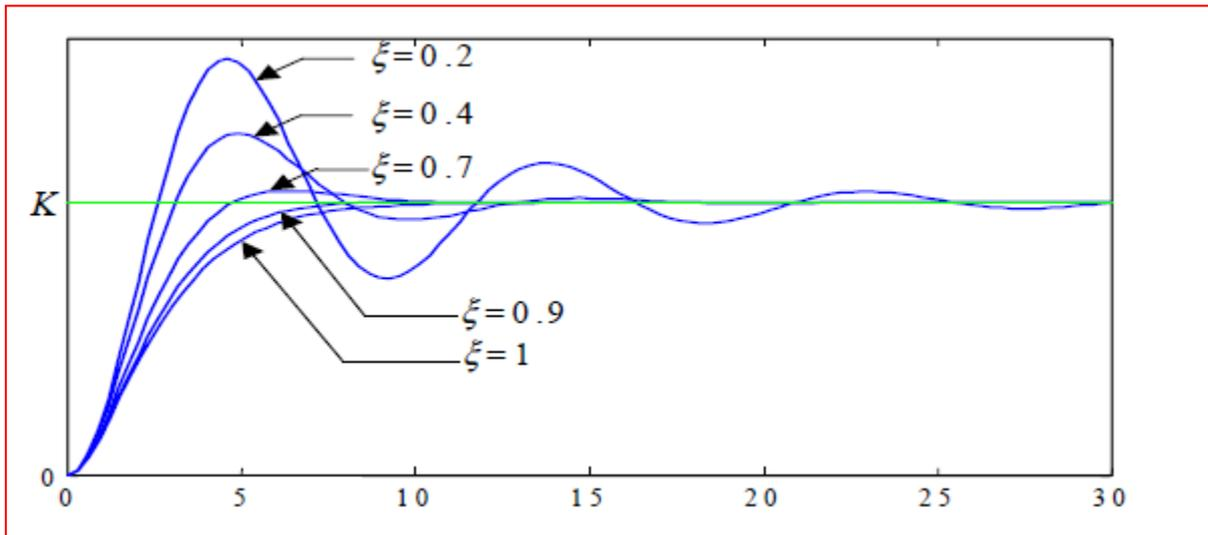
Fig. 3-13 : Réponses indicielles d'un système du 2<sup>ème</sup> ordre en fonction de  $\xi$
