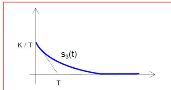
Fig. 3-11 : Réponse impulsionnelle d'un système du 1<sup>er</sup> Ordre
