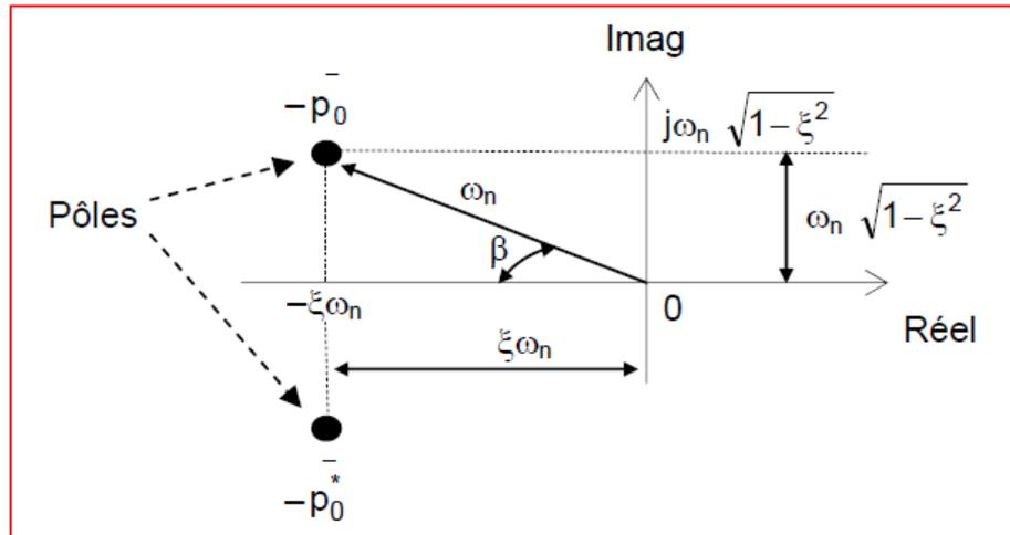
Fig. 3-12 : Relations entre les paramètres d'un système du 2nd ordre dans le plan Complexe
