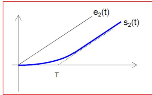
Fig. 3-10 : Réponse d'un système du 1er Ordre à une rampe (tracée pour  $K=1$ )
