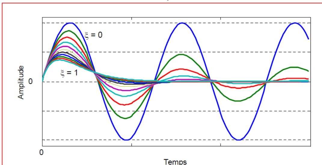
Fig. 3-14 : Réponses impulsionnelles d'un système du 2nd ordre en fonction de  $\xi$
