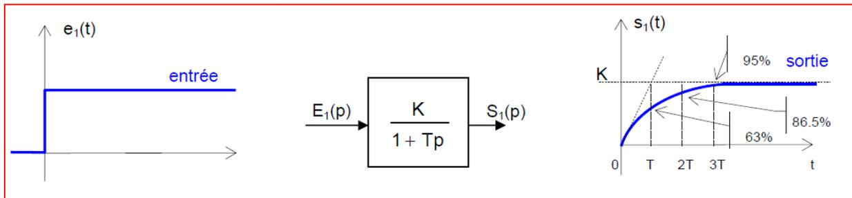
Fig. 3-9 : Réponse indicielle d'un système du 1<sup>er</sup> Ordre
