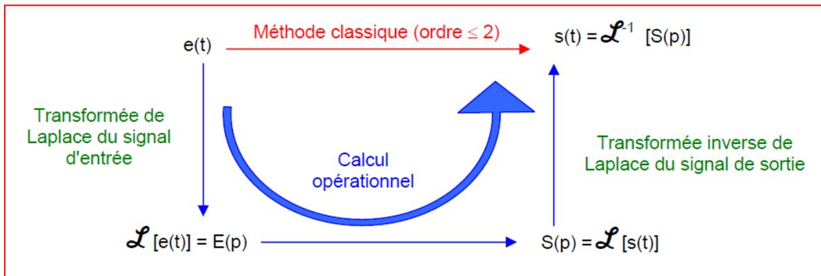
Fig. 2-4 : Détermination de la sortie du système par la méthode classique et par le calcul opérationnel
