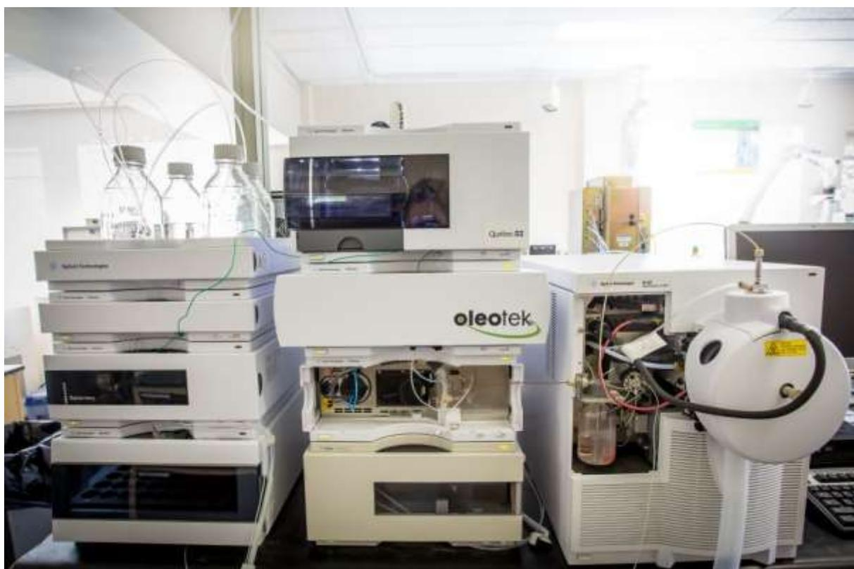
LC-MS / Chromatographe liquide couplé à un spectromètre de masse - Oleotek
