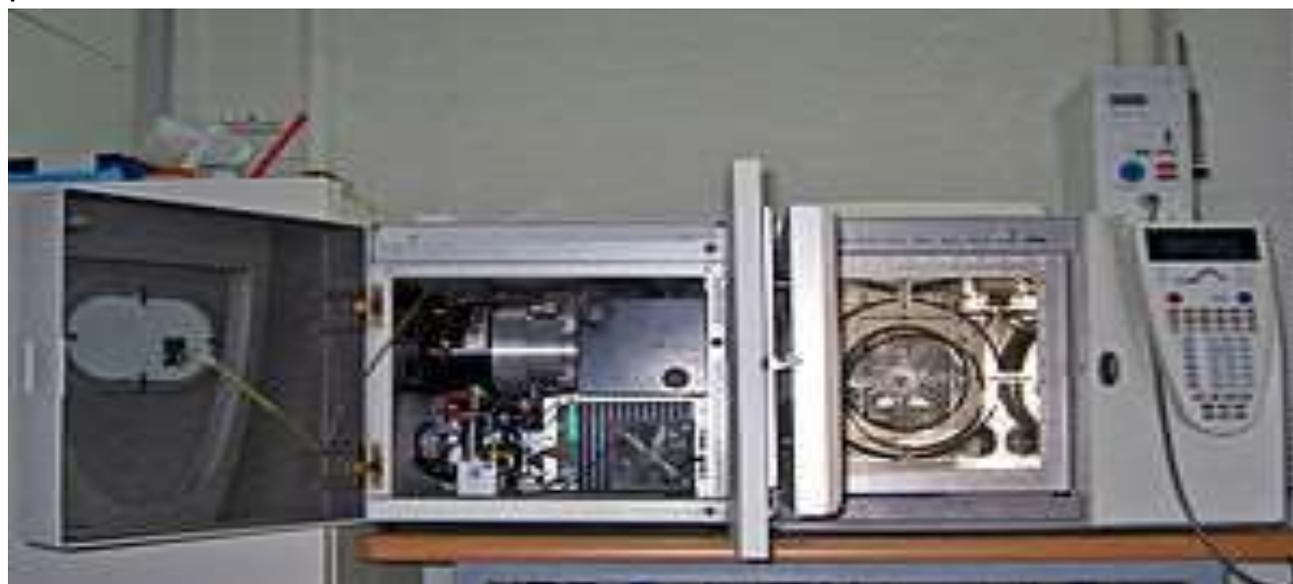
**Fig.III.1 : Schéma de l'appareil de la chromatographie en phase gazeuse couplée à la spectrométrie de masse**
