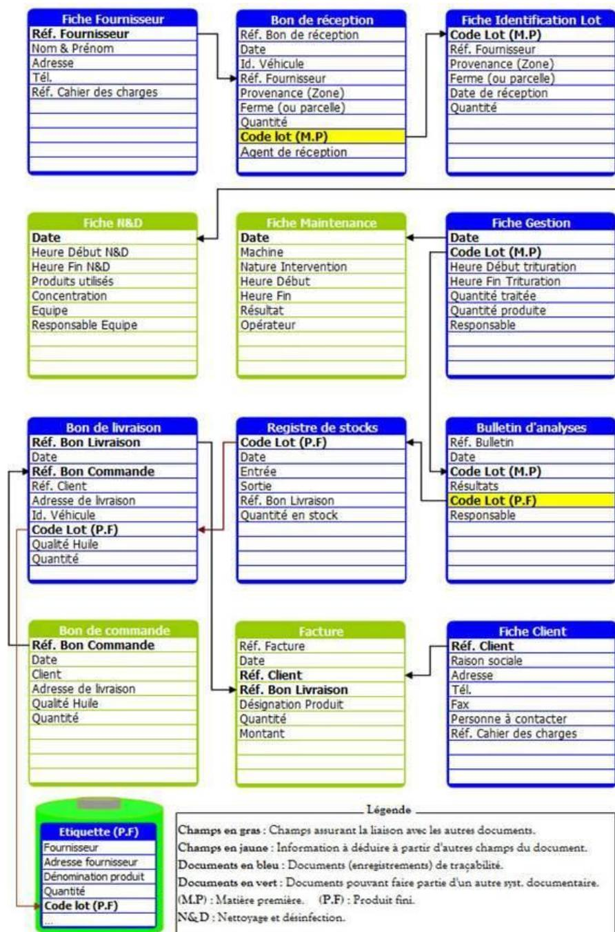
**Figure 6** : Schéma de traçabilité (Relation entre les documents de Traçabilité)
