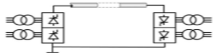
(b) Monopolaire- avec retour métallique
