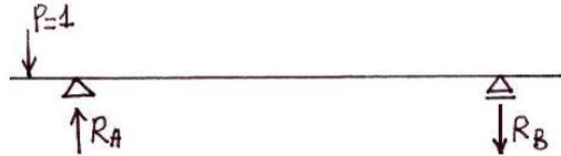
2- b)- La réaction maximale de l'appui A est obtenue en chargeant la partie positive de la ligne d'influence de  $R_A$ , soit
