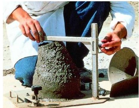
**Figure1** : Essai d'affaissement
