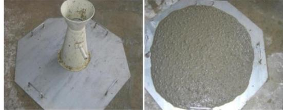
Figure 1. Essai d'étalement au cône d'Abrams
