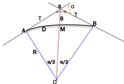
**Figure1 : Raccordement circulaire**
