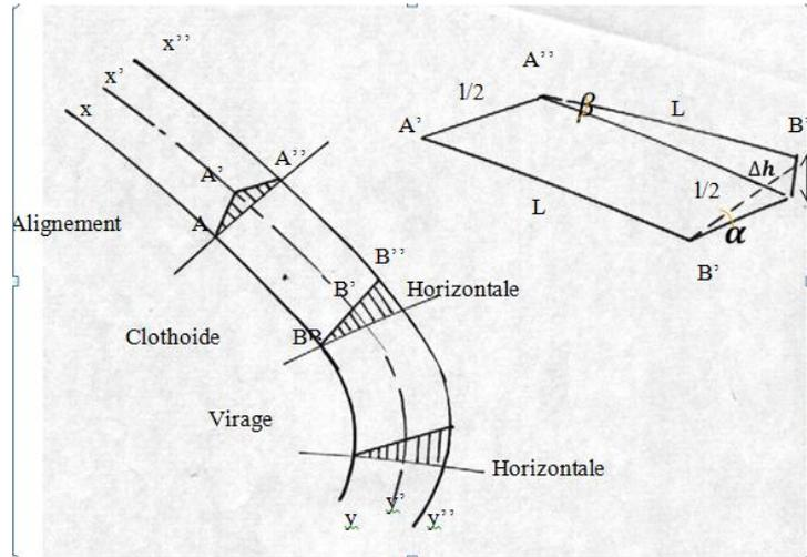
**Figure 21** : Variation de la forme superficielle de la chaussée
