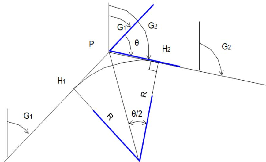
Principe de calcul des points du raccordement circulaire.
