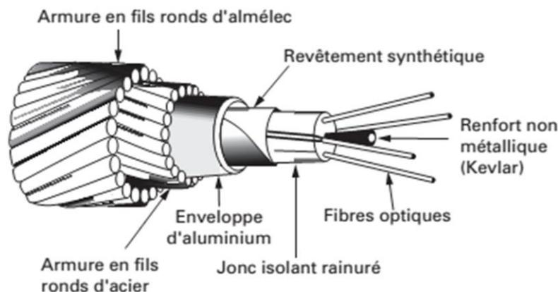
**Fig 8.** Câble de garde à fibres optiques incorporées.
