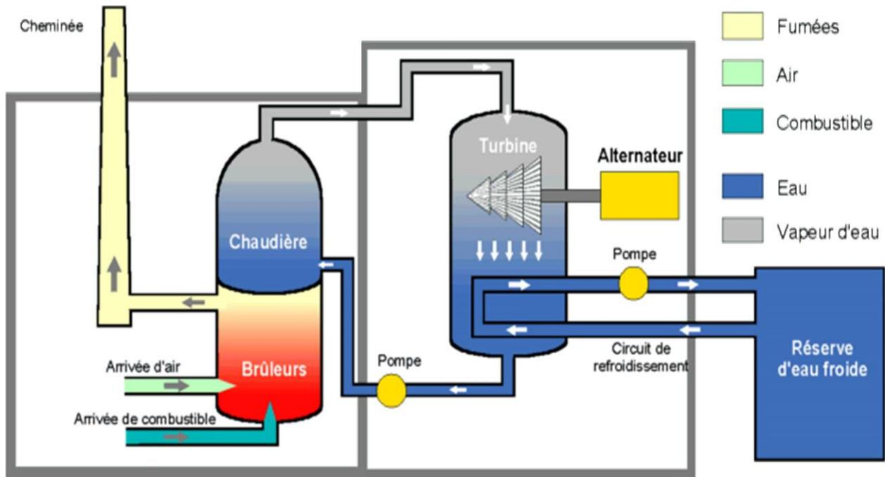
Fig.2. Eléments d'une centrale thermique.
