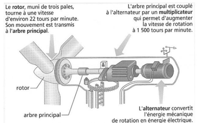
**Fig.5.** Eléments d'une éolienne.
