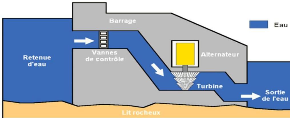
**Fig.4.** Eléments d'une centrale hydraulique.
