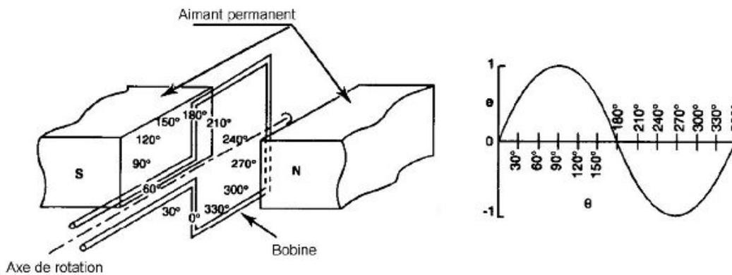
**Schémas simplifiés du principe de l'alternateur**
