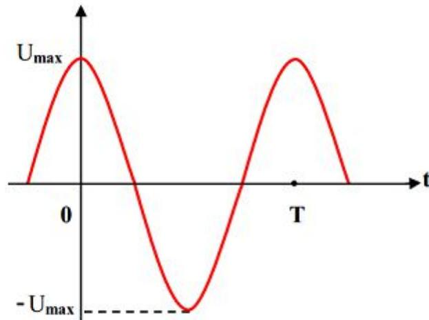
**Figure I-2.** Caractéristiques des grandeurs sinusoïdales
