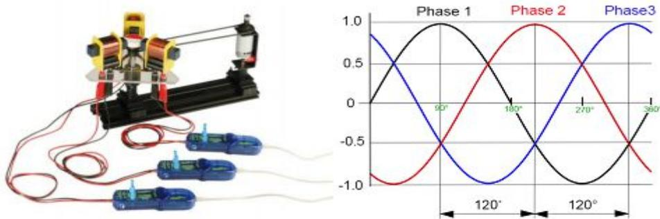
**Figure 3.7** Système triphasé.
