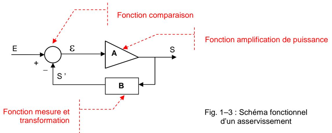
Fig. 1-3 : Schéma fonctionnel d'un asservissement
