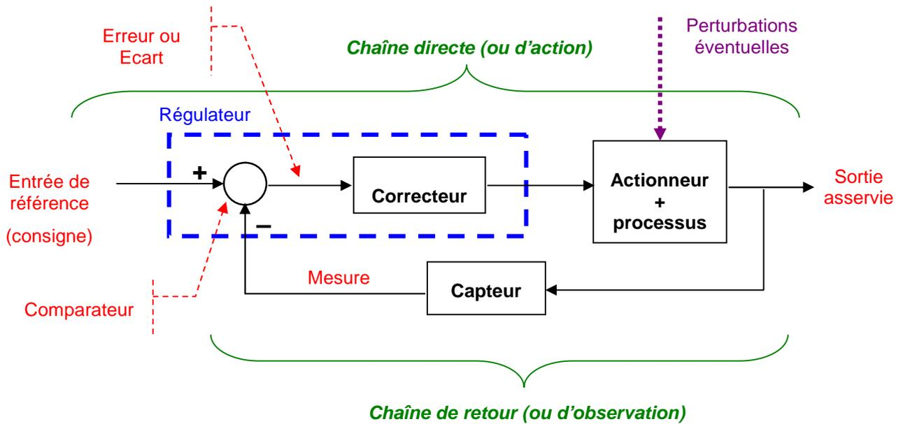
Fig. 1-4 : Organisation fonctionnelle d'un système asservi (schéma fonctionnel)
